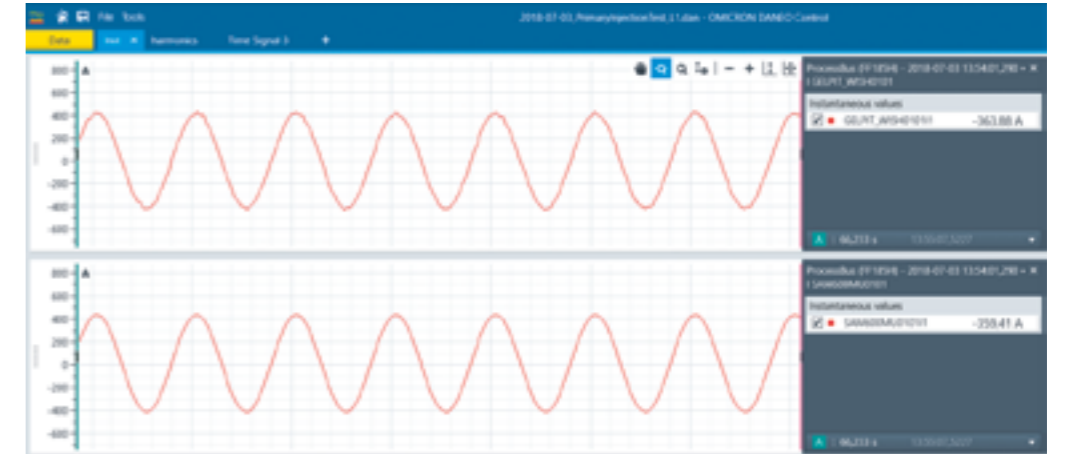
Abb. 7 Signalkurvenvergleich mit OMICRONs DANE0 400
